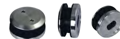
Konektor fiksni zid - staklo odmak za 10 mm staklo: 6 mm odmak za 6 mm staklo: 10 mm debljina stakla 6 - 12 mm priprema stakla Ø 27 mm inox SAT
